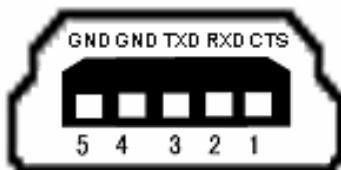
打印机的数据缓存为 8K 字节, 当发送数据小于 8K 字节时, 可不用流控方式, 引脚的具体功能如下表:
